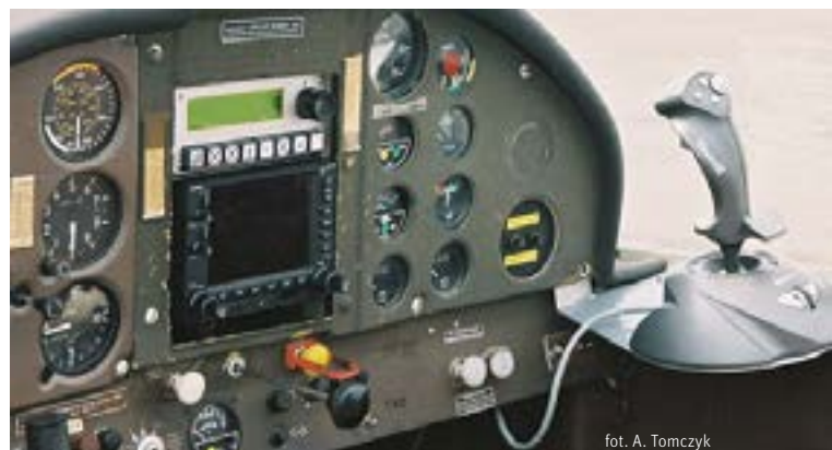
Fot. 2. Elementy systemu SPS-1A zabudowane w kabinie pilota.
