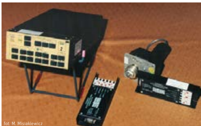
Fot. 1. Moduł główny autopilota APC-1P z pulpitem sterowania, mechanizm wykonawczy oraz dwa sterowniki ze wzmacniaczami mocy.
